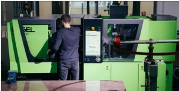
Die ENGEL e-motion 50/30 tl ist eine Spritzgießmaschine mit vollelektrischem Kinematiksystem
